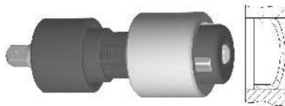
Este tipo de expandidor é utilizado para instalar calota de vedação em blocos de motores, cabeçotes, etc.
