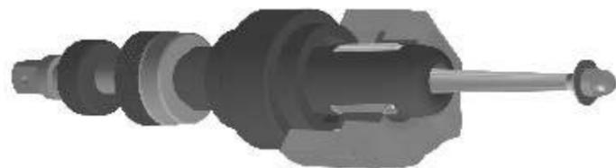
Com este expandidor fixa-se firmemente e com garantia de estanqueidade a sede no corpo da válvula. Pode ser utilizado, por exemplo, para fixar uma sede de aço inoxidável num corpo de válvula de bronze.
