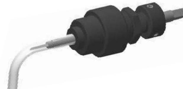
Neste expandidor o curso da haste foi reduzido e a porca frontal, substituída por um dispositivo de retenção na parte traseira, reduzindo a projeção da haste e permitindo expandir tubos que apresentem uma curvatura bem próxima da região expandida.
